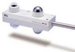
**Net-Radiômetro:** Medidor de saldo de radiação, que conta com 02 (dois) piranômetros e 02 (dois) pirgeômetros, a 180°, sendo normalmente um piranômetro e um pirgeômetro apontando para a terra e outro piranômetro e outro pirgeômetro apontando para o céu.
