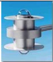
**Albedômetro:** Medidor de radiação de albedo, que conta com 02 (dois) piranômetros, a 180°, sendo normalmente um apontando para a terra e outro apontando para o céu.
