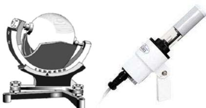
**Heliógrafo e "Sunshine Duration":** Medidores de duração dos raios solares em um ciclo de 24 horas, sendo o heliógrafo um equipamento totalmente mecânico e o "sunshine duration" sua versão modernizada com comunicação digital.
