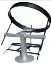
**Disco de sombreamento Lateral (Shadow Ring):** Acessório para ser utilizado com um piranômetro.
