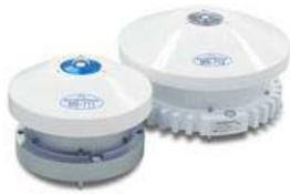
**Espectroradiômetro:** Medidor de bandas espectrais incidentes na radiação solar.
