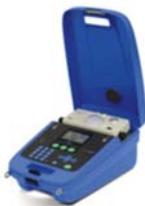
**Traçador de Curva (Curve Tracer):** Equipamento para traçar ou verificar a curva I-V, nas associações de módulos fotovoltaicos.
