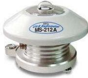
**Medidor de UV:** Medidor de radiação ultra-violeta (UV), normalmente UVA, UVB e UVE.
