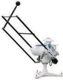
**Rastreador Solar (Sun Tracker):** Sistema eletromecânico que segue a trajetória do sol, utilizando um conjunto de motores, especialmente projetado para fixação de diversos sensores, tais como piranômetros e pireliômetros.
