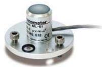
**Radiômetro Foto-diodo:** Equipamento para medir a radiação solar em faixas espectrais mais estreitas e específicas.
