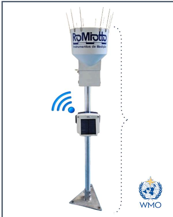
**Estação Pluviométrica** é um sistema desenvolvido e montado pela RoMiotto, para medição de quantidade e intensidade de chuva, com gravação de dados e envio destes, através de rede celular, diretamente para a plataforma [SENSORII](#), onde além do monitoramento em tempo real, é possível fazer o download dos dados e plotar gráficos.
