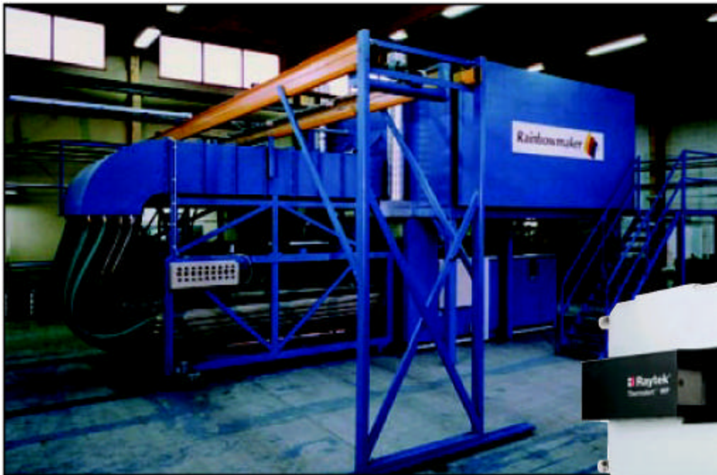
O GS100 permite a análise da temperatura, em tempo-real, em processos de dobramento do vidro (Foto: Cortesia da SIG Combibloc, Wittenberg, Alemanha)
